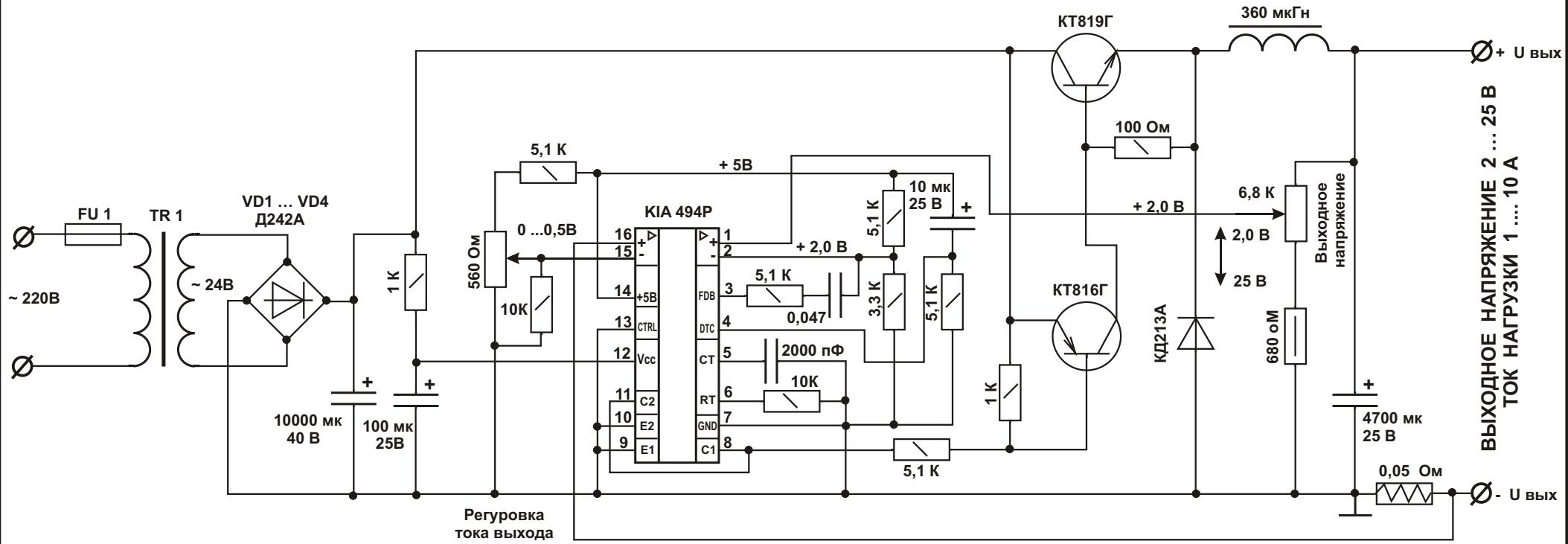
ПРИНЦИПИАЛЬНАЯ СХЕМА ИМПУЛЬСНОГО БЛОКА ПИТАНИЯ
