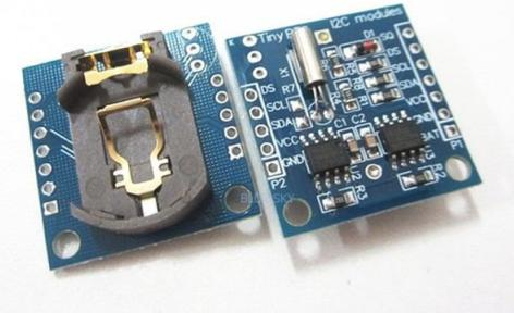
Чтобы не тратить время на поиск компонентов, я приобрёл на Aliexpress вот такой готовый модуль всего за 40 центов. В состав модуля кроме держателя батарейки, цепей её подзарядки, кварца и т.п., входит микросхема памяти, к тому же есть возможность запаять датчик температуры DS18B20.
