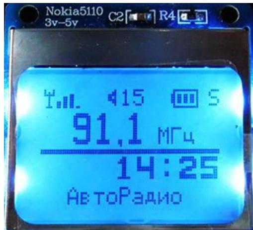
В верхней строке индикатора выводится уровень принимаемого сигнала, в виде четырёх столбиков разной длины, уровень громкости от 0 до 15, изображение батарейки с условным уровнем заряда и буквами "M" и "S" вид передачи – «моно» или «стерео». Ниже над разделительной линией выводится частота принимаемой станции, а под линией – время в формате часы и минуты.
