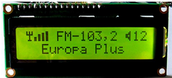
При первом включении радиоприёмника, необходимо отрегулировать контрастность изображения на дисплее при помощи подстроечного резистора R1. При неправильной установке этого резистора изображение может полностью отсутствовать.
