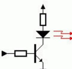
Простая транзисторная схема может быть использована для управлять СИД. Транзистор с соответствующей  $h_{FE}$  и скорость переключения должны быть выбраны для этой цели.
