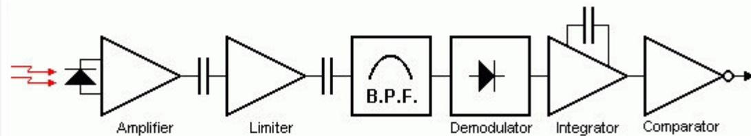
На картинке выше вы можете видеть типичная блок-схема такого ИК-приемник. Не пугайтесь, если Вы не понимаете эту часть описания, ибо все встроено в один электронный компонент.
