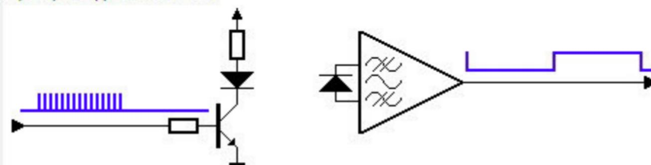
На картинке выше вы можете увидеть модулированного сигнала вождения СИД ИК передатчика на левой стороне. Продетектированный сигнал выходит из приемник на другой стороне.
