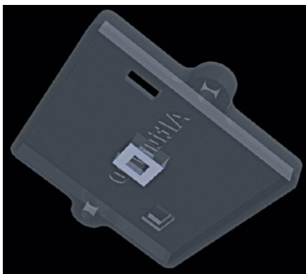
Рис. 4. Выравнивание детали по плоскости платы
