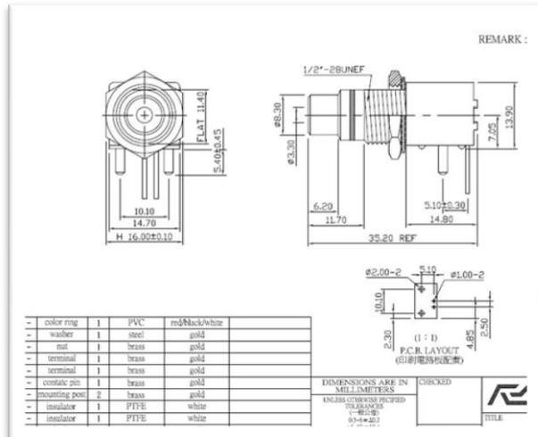
гайка 12,5 мм диаметр диаметр рекомендуется установка отверстие 13,0 мм ~ толщина 13,5 мм ≤ 4,0 мм
