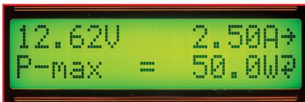
**Bild 1: Anzeige im Konstantstrombetrieb**
