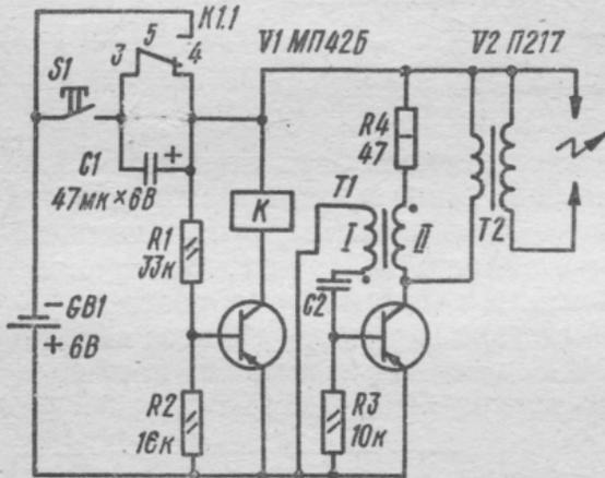
Рис. 6.15. Схема электронной газовой зажигалки
