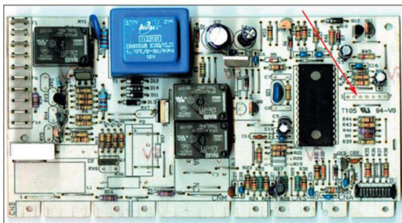
Рис. 1. Внешний вид модуля MINI AC (без радиатора)
