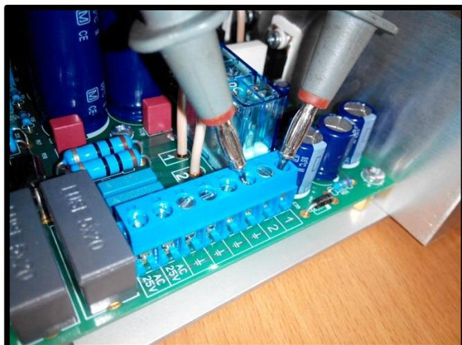
При подключении акустики, учитывайте полярность, «горячий» провод (**плюс**) на - **1**, «холодный» провод (**минус**) - на землю. Аналогично с вторым каналом.
