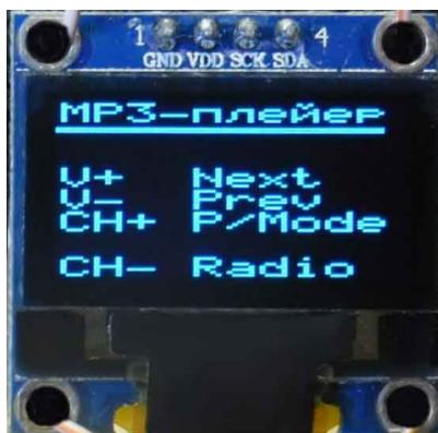
Для перехода в режим MP3-плейера нужно нажимать в течение 3 секунд кнопку CH-. В результате на дисплей выводится информация о назначении управляющих кнопок.
