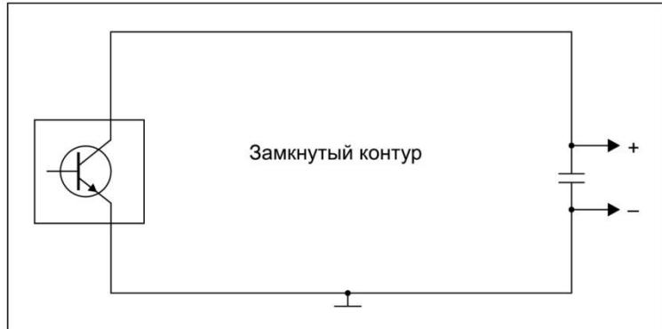
Рис. Возникновение замкнутого контура, образованного шиной «земли» и питания
