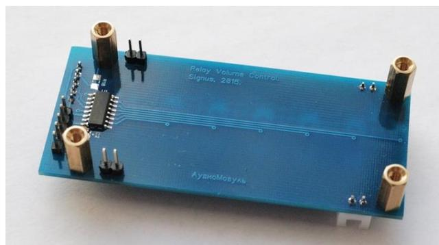
Для соединения регулятора громкости и селектора между собой используются стойки высотой 12мм. Для управления всей конструкцией достаточно подключить шину управления к разъему X5 Control IN. Крепление конструкции к корпусу осуществляется гайками входных разъемов.
