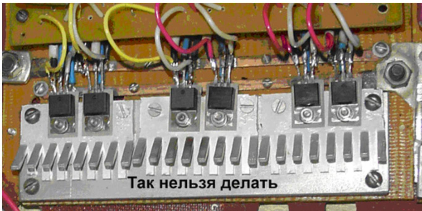
Рис.5 Так нельзя делать силовой блок на большие токи.
