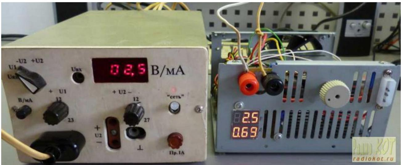
На переднюю панель установлены гнезда для подключения нагрузки и стандартный разъем MOLEX для тестирования компьютерных блоков питания (оставлен только вход +12В).
