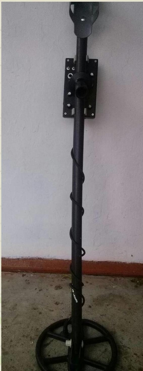
Пришли на место где лежат несметные сокровища. Дискриминацию выставили на ноль. Переключатель режимов в положение – **Только цвет**. Регулятор чувствительности на начало звука и чуть назад что бы не было глюков (максимальная чувствительность). Регулятор баланса грунта **НЕдокрутили** до точки отсечения феррита (ТОФ). И опустили датчик к грунту. Обязательно в
