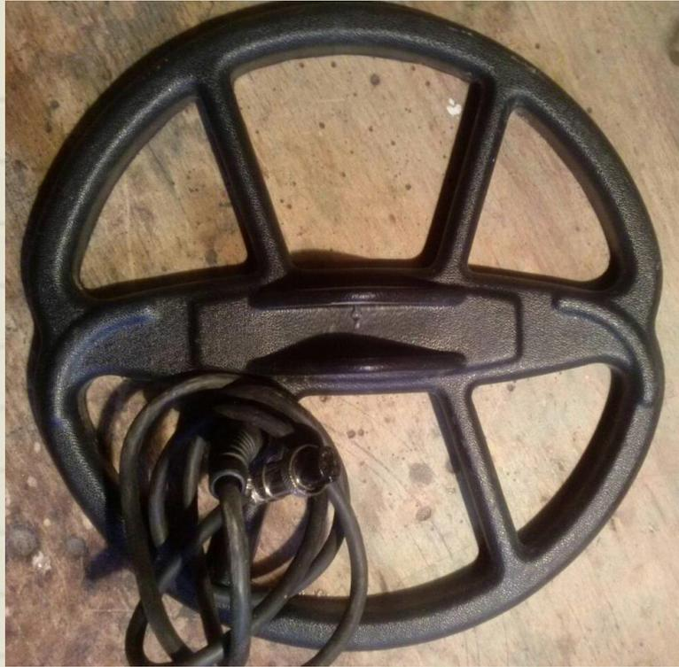
Самое плохое что могут сделать новички это использовать тонер с лазерного принтера вместо графитового порошка. А еще покрывают датчик серебрянкой, после чего он перестает работать.
