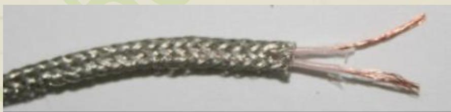
Диаметр одной жилы желательно чем больше, но не менее 0,35 мм. Откусываем два куска необходимой длиной (около 1 – 1.5 м. Стандарт – 1.2 м). Протягиваем этот бутерброд в резиновую или силиконовую трубку подходящего диаметра. Далее два вывода цепляем конкретно на приемную катушку RX, а другие два вместе с экраном на передающую катушку TX. Такой вариант уже второй год работает на моем Терминаторе, без глюков и без обрывов. Единственная подсказка, не брать в
