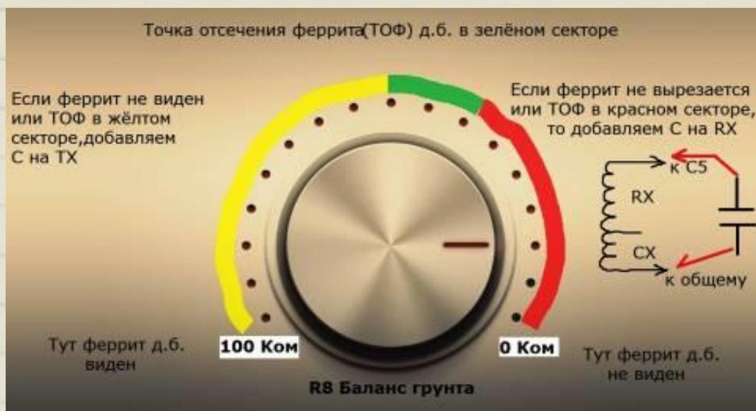
Берём кусочек феррита, и машем над датчиком. При этом крутим регулятор БГ (баланса грунта). Здесь может быть три варианта:
