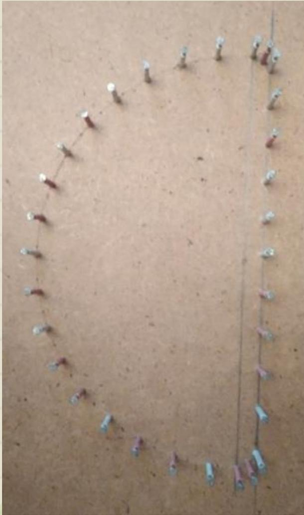
Далее отступаем от края контура внутрь на сантиметр (подбираем эмпирическим путем) и забиваем по внутреннему контуру обычные гвозди с откушенными шляпками. Частота забивки прямо пропорциональна величине катушки и обратно пропорциональна жадности создателя.
