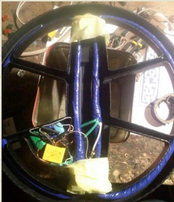
Двигать половинку катушки надо очень аккуратно, буквально по пол миллиметра, потому что амплитуда растёт и падает очень резко и вам надо поймать то положение половинок друг относительно друга, при котором будет минимальная амплитуда, и в этом положении зафиксировать вторую половинку. Оставьте один из концов катушки в корпусе чуть длиннее. Это будет настроечная петля. С ее помощью Вы потом сможете подогнать разбаланс между катушками.
