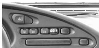
Рис.14 БК установлен ("CHEVI - NIVA")
