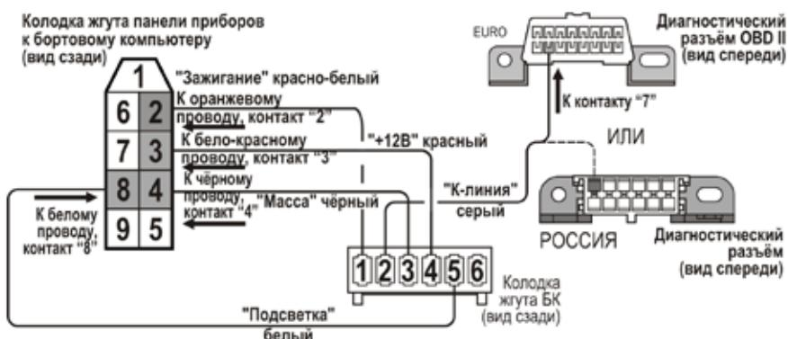
Рис.5 Схема подключения (“САМАРА - 2”)
