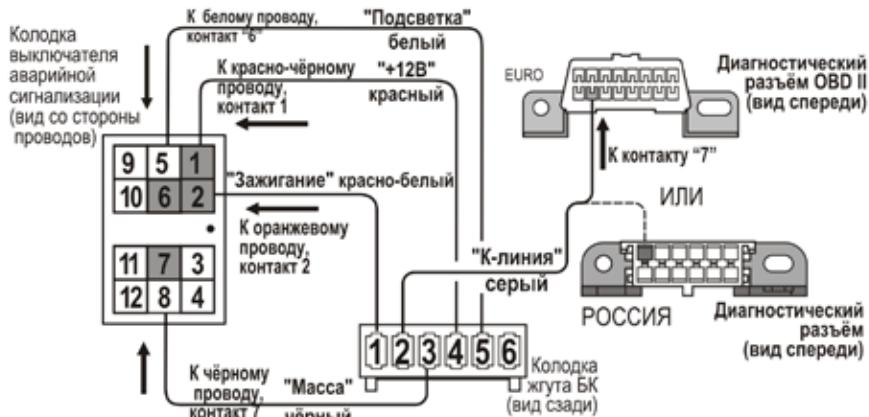
Рис.12 Схема подключения ("CHEVI - NIVA")
