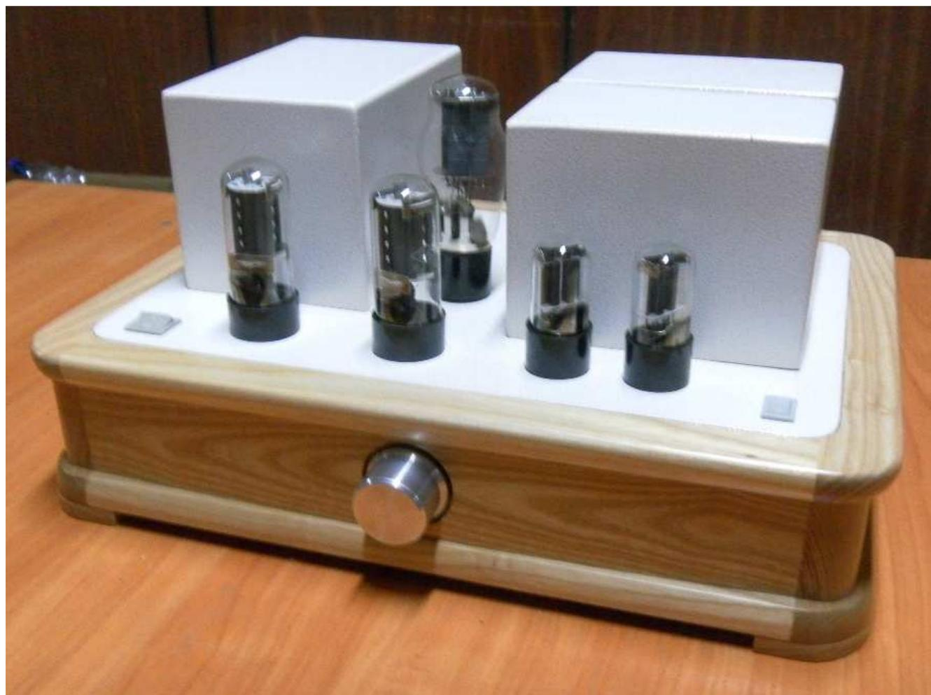
В заключение несколько слов о трансформаторах из доступных материалов. Выходной трансформатор сделан на магнитопроводе и каркасах от ТС-160 и рассчитан на нагрузку 4 и 8 Ом. На каждой катушке размещено:
