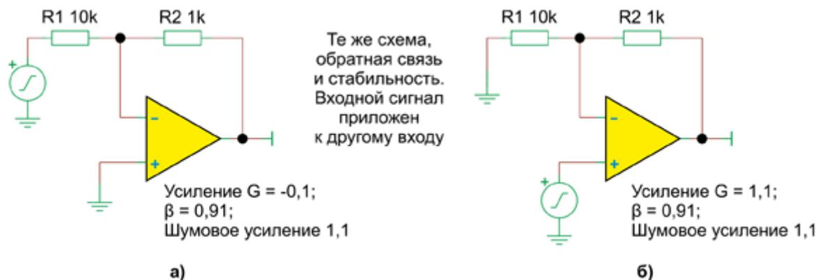
Рис. 45. Инвертирующий (а) и неинвертирующий (б) усилители имеют одинаковый коэффициент обратной связи и равный запас устойчивости, но входной сигнал подается на разные входы
