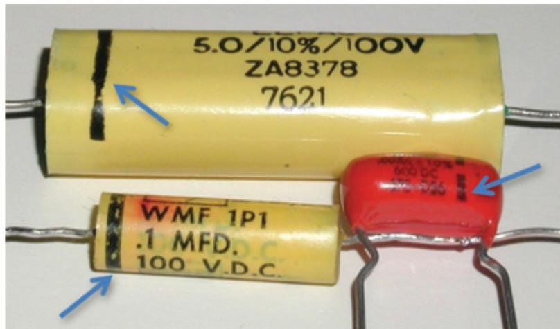
Рис. 21. Каково назначение черных полос на корпусе пленочных конденсаторов?
