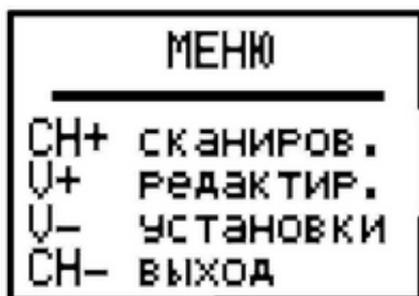
После включения приёмника, по умолчанию, устанавливается рабочий режим перебора сохранённых в памяти радиоканалов (см. рис. выше). Переход в другие режимы работы производится из этого рабочего режима. В нижней строке выводится номер принимаемой станции, если принимаемая станция передаёт данные RDS, то загорается светодиод VD1 и в нижней строке отображается принимаемая информация. При слабом или зашумлённом сигнале сигнал RDS приниматься не будет, несмотря на то,
