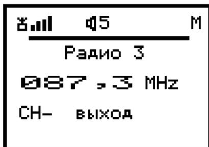
сканирование. Переход в режим сканирования производится если при включении удерживать в нажатом состоянии кнопку V+ до тех пор, пока радиотюнер не начнёт сканирование и на экране дисплея появится информация, показанная на рисунке слева. После этого кнопку V+ можно отпустить. При обнаружении радиостанции в верхней строке дисплея отображается уровень принимаемого сигнала, установленная пользователем громкость и режим воспроизведения «моно» или «стерео» (буквами М или С).
