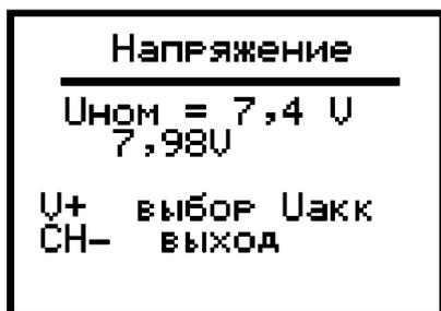
В приёмнике предусмотрен контроль заряда литиевого аккумулятора питания. На экран дисплея выводится уровень заряда аккумулятора в виде пиктограммы. Чтобы индикатор заряда работал правильно, необходимо как можно более точно измерить напряжение батареи. Для этого имеется особое меню настройки измерителя напряжения.
