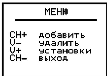
Для перехода к различным функциям программы приёмника нужно войти в основное меню программы, для чего требуется одновременно нажать на кнопки CH+ и CH- при этом на экране дисплея появится информация, показанная на рисунке слева. Здесь выводятся названия кнопок и действия, к которым можно перейти, нажимая на соответствующие кнопки. Т. е. можно добавить или удалить канал приёма в памяти, а также перейти к установкам даты, времени и параметров звука.
