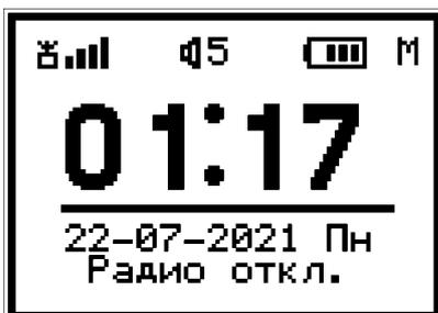
В программе предусмотрен переход в режим часов, в котором радиоприёмник и питание усилителя отключаются, а на дисплей выводится текущее время и дата. Для перехода в режим часов, а также и для выхода из этого режима, нужно одновременно нажать на кнопки V+ и V-.
