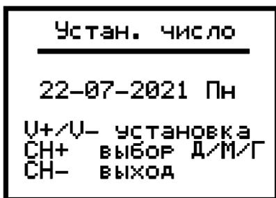
параметра отображается в верхней строке, а установка числа также производится кнопками V+ и V-. При нажатии на кнопку CH+ в этом режиме последовательно выбирается установка числа месяца, месяц, год и день недели. При следующем нажатии на кнопку CH+ будет снова вызван режим установки часов, и так по кругу. После установки нужного значения времени и даты нужно нажать на кнопку CH-, после чего все значения будут записаны в память микросхемы DS3231 и приёмник перейдёт в рабочий режим.
