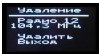
Если при сканировании ошибочно была сохранена в памяти частота помехи, или на каком-либо канале плохие условия приёма, то такую частоту (как и любую другую) можно удалить из памяти частот радиоканалов. Для этого нужно войти в меню редактирования, выбрать команду «Удалить» и нажать на кнопку энкодера. При этом на экране дисплея появится информация,
