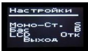
При переходе из основного меню в меню «Настройки» на дисплей выводится информация, показанная на фото слева. Из меню «Настройки» можно перейти к установке режима воспроизведения «Моно» или «Стерео», к переключению усиления басов, а также установить постоянный или отключаемый режим свечения дисплея.
