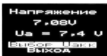
Для правильного отображения заряда батареи необходимо настроить измеритель напряжения, входящий в состав приёмника. Для входа в меню настройки измерителя напряжения нужно перед включением питания нажать кнопку энкодера и удерживать её до тех пор, пока на экране дисплея не появится информация, показанная на рис. слева. В верхних строках указывается измеренное напряжение аккумулятора. Посередине экрана выводится номинальное напряжение батареи. В нижних строках выводятся строки управляющего меню.
