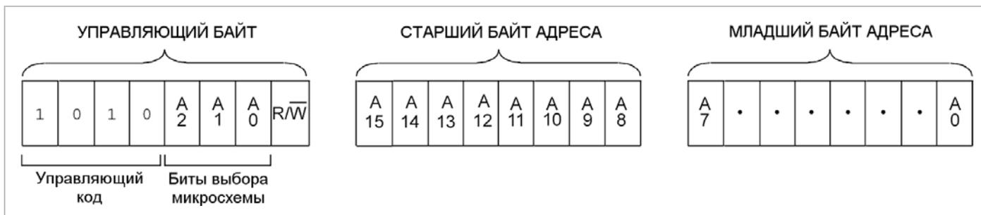
Рис. 5-2. Распределение битов адресной последовательности
