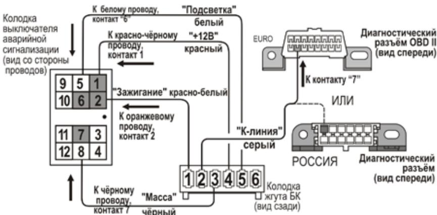
Рис.12 Схема подключения ("CHEVI - NIVA")
