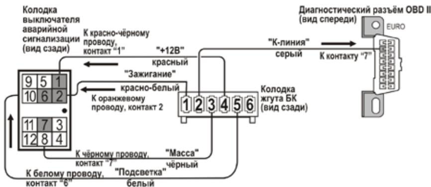
Рис.9 Схема подключения ("КАЛИНА")
