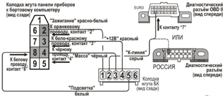
Рис.5 Схема подключения ("САМАРА - 2")
