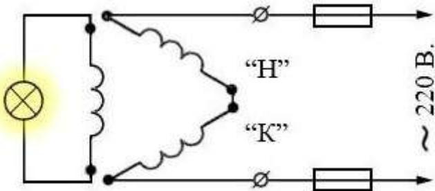
Соответственно, полное отсутствие накала лампы или отклонения стрелки вольтметра – свидетельство отсутствия ЭДС в третьей обмотки, следовательно, последовательно включенные обмотки соединены своими "началами" или "концами". Таким образом, определив "начала" и "концы" двух обмоток, выводы маркируются.
