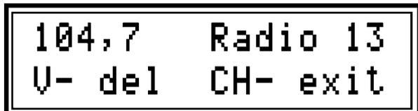
удалить из памяти частот радиоканалов. Для этого нужно настроиться на данный канал и затем войти в меню редактирования и нажать на кнопку V-. При этом на экране дисплея появится информация, показанная на фото слева. Если теперь снова
