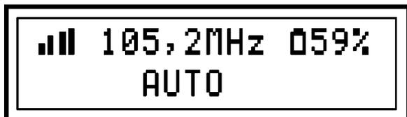
одновременно нажать на кнопки CH+ и CH-. При этом в нижней строке дисплея появится название действующего в данный момент режима настройки на станцию – «PRESET» или «AUTO». В дальнейшем, для настройки на станцию вверх или вниз по диапазону нужно нажать соответственно
