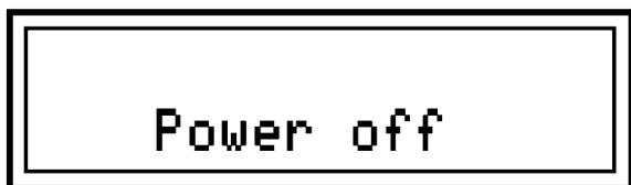
Для выключения питания нужно снова кратковременно нажать на кнопку SB5, при этом напряжение на входе порта PB7 через диод VD3 будет близким к логическому нулю. На это микроконтроллер отреагирует тем, что сначала выведет на дисплей сообщение «Power off» (см. рис. справа), затем снимет управляющее напряжение на базе VT4 и, следовательно, ключ VT3 закроется и питание приёмника будет отключено.
